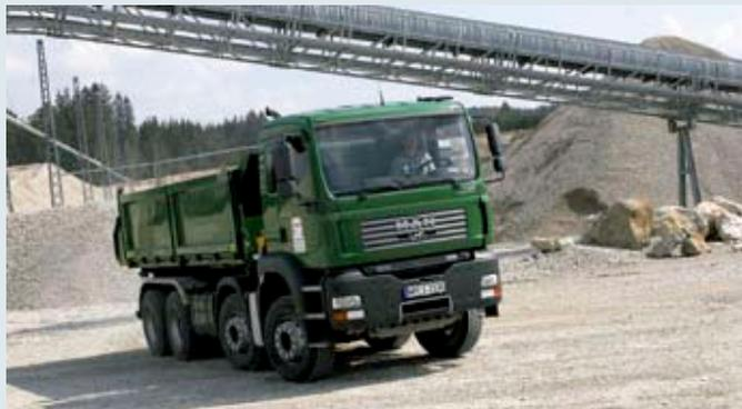
ных формул от 4x2 до 8x8. Для российского рынка предназначены 21-тонный самосвал MAN 33.363DFK-WW (6x4) с 13-кубовым кузовом и строительное шасси 41.360 (8x4), оснащенные 360-сильным дизелем, 16-ступенчатой коробкой передач и кабиной серии М.
