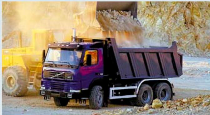
специализированных машин с колесными формулами от 4x2 до 8x4. Правда, четырехосники у нас столь непопулярны. Одной из особенностей Volvo заключается в том, что машины сочетают повышенный дорожный просвет (355 мм под картером переднего и 345 мм под картером заднего мостов) с низкой погрузочной высотой самосвального кузова. Рама большей прочности способна воспринимать как вертикальные, так и значительные скручивающие нагрузки.
